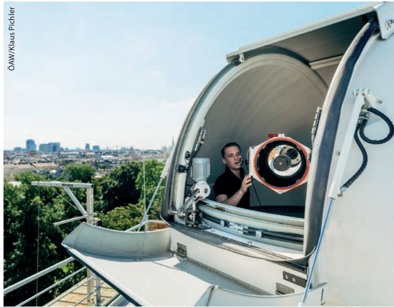
Ein Teleskop auf dem Dach des Instituts für Quantenoptik und Quanteninformation (IQOQI) ist eine der Bodenstationen
