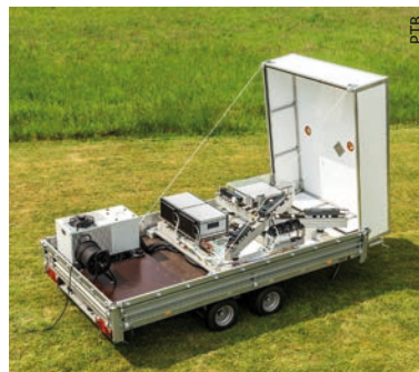
Das LIDAR-System der PTB findet Platz auf einem vier Meter langen Anhänger.
