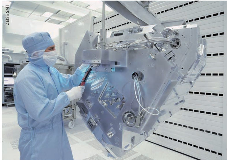
ZEISS stellt die hochkomplexen Optiken für die EUV-Lithographie her. Hier justiert ein Mitarbeiter die EUV-Optik.
