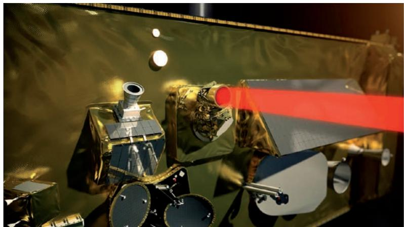
Die Laserterminals an Bord der EDRS-Satelliten entwickelte und baute das DLR. Sie ermöglichen die Übertragung von Daten in Echtzeit mit Raten bis zu 1,8 Gbit/s.
