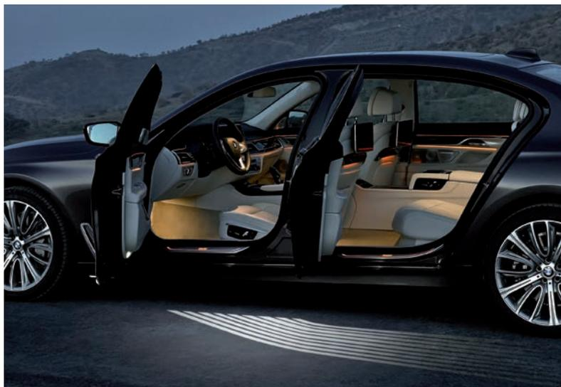
Mit Hilfe einer Umfeldbeleuchtung lässt sich der Boden entlang des Autos von den Fronttüren bis zum Heck erhellen.
