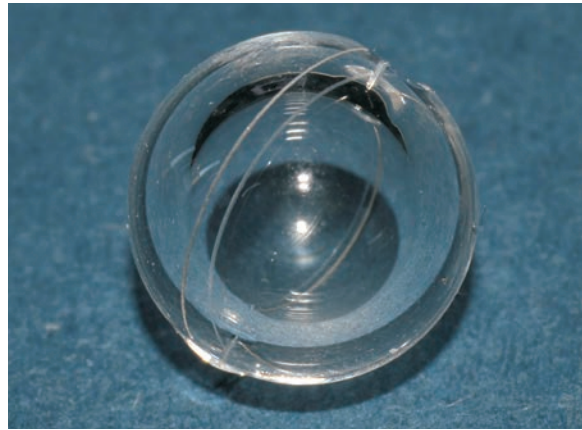
Abb. 4 Diese Hohlkugel aus Quarzglas wurde mittels Diffusionsschweißen aus zwei Halbschalen zusammengesetzt ( R_{\text{in}} = 4 \text{ mm} , R_{\text{out}} = 6 \text{ mm} ). Das ^3\text{He} -Gas gelangt beim Erhitzen der Zelle über Permeation von außen nach innen.
