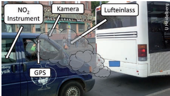
Mit dem Heidelberger Messgerät ist Stickstoffdioxid direkt in den Autoabgasen erfassbar.
