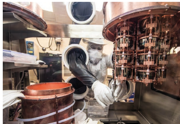
Der Prototyp-Detektor Majorana soll zeigen, ob der neutrinolose Doppel-Betazerfall möglich ist.
