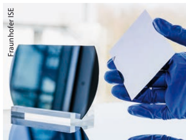
Nach dem neuen Verfahren hergestellter Wafer (rechts), wiederverwendbares Substrat (links)
