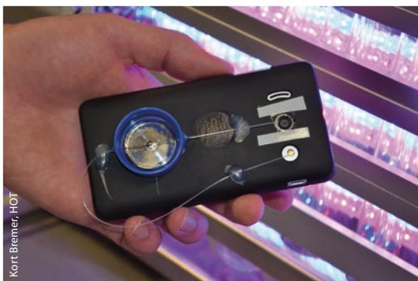
Smartphone, präparierte Glasfaser und Beugungsgitter – mehr bedarf es nicht für eine Brechungsindexmessung.
