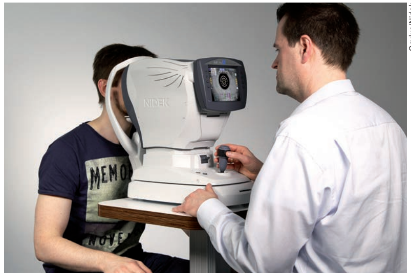
Durch den Blick ins Autorefraktometer lässt sich der Sehfehler eines Menschen bestimmen. Die Messung erfolgt mit Infrarotlicht und weitgehend automatisiert.
