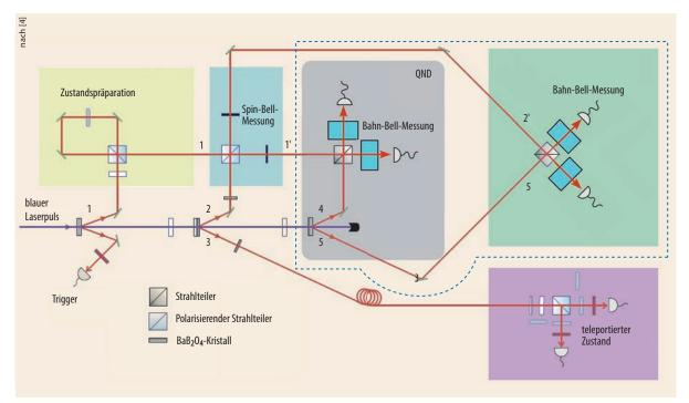
Abb. 1 Die Teleportation mehrerer Freiheitsgrade eines Photons erfordert einen komplexen Aufbau. Drei Photonenpaare werden erzeugt und Photon 1 des ersten Paares in einem beliebigen Zustand präpariert. Das Triggerphoton stellt nur sicher, dass das Experiment richtig initialisiert wurde. Das hyperverschränkte Paar (2, 3) vermittelt die Teleportation der beiden Freiheitsgrade. Die erste Bell-Messung am Spin verläuft herkömmlich. Damit danach die Bell-Messung am Bahndrehim-
