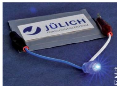
Festkörper-Akku mit Lithium-Kobalt-Oxid-Kathode, Lithium-Metall-Anode und teilsubstituiertem Lithium-Lanthan-Zirkonat als Elektrolyt.
