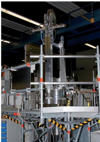
An dieser Versuchsanlage erproben die Wissenschaftler den gesamten Ablauf der Bestrahlung von niedrig angereichertem Uran zur Produktion von Molybdän-99. Rund 7,5 Meter groß ist der Aufbau und reicht noch fast vier Meter in den Keller hinein.
