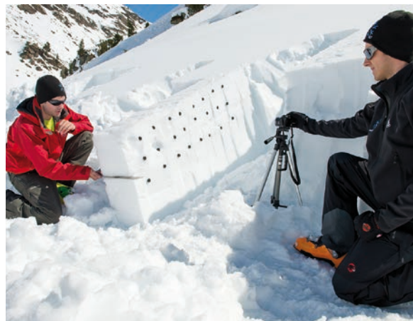
Herwijnen in eine Schwachschicht, um herauszufinden, ob sich ein Bruch ausbreitet (rechts). Dank der schwarzen Markierungen lässt sich ein Film des Vorgangs später im Detail auswerten.
