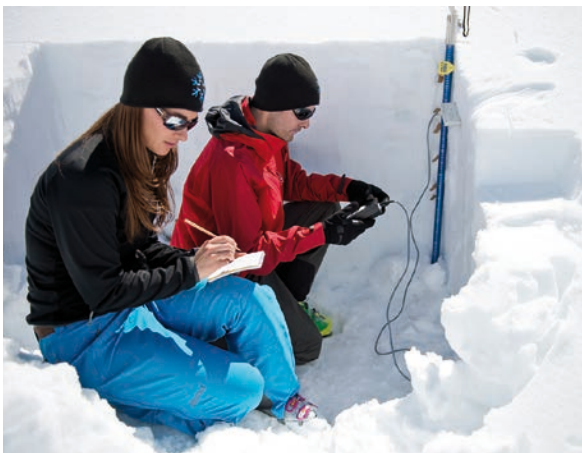
Alec van Herwijnen (mit roter Jacke) nimmt ein Schneeprofil auf (links). Mit der Denoth-Sonde lässt sich die Schneedichte von trockenem Schnee bzw. der Flüssigwassergehalt in feuchtem Schnee messen. Beim „Propagation Saw Test“ sägt van
