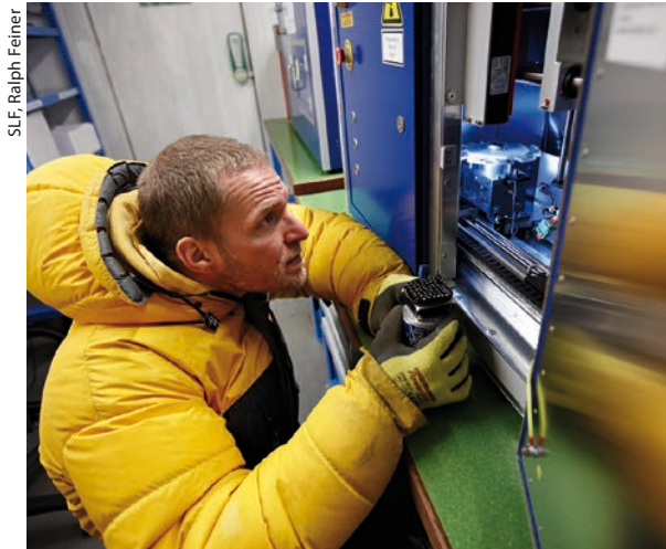
Henning Löwe setzt im Kältelabor bei -15 Grad Celsius eine Schneeprobe in einen Computertomographen.
