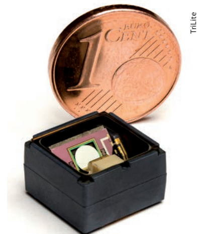
Ein Bildpunkt des autostereoskopischen Displays enthält Laserdiode und MEMS-Spiegel.
