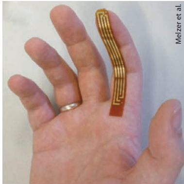
Mit dem flexiblen Hall-Sensor lassen sich Fingerbewegungen detektieren.
