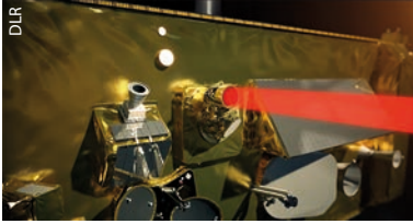
Das neue Laser-Kommunikationsterminal ist deutlich kleiner und leichter als die Vorgängertechnologie.
