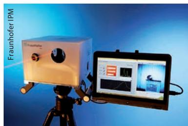
Das laserbasierte System misst austretendes Methan berührungslos aus bis zu 15 Metern Entfernung.
