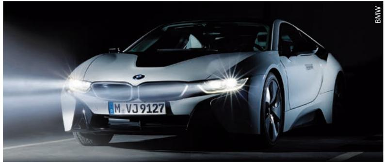
Abb. 1 Bislang bieten zwei Hersteller Laserlicht in Serienfahrzeugen an – BMW für seinen Hybrid-Sportwagen i8 und Audi für seinen Supersportwagen R8 LMX. Die hohe Leuchtdichte der Laser-
