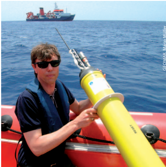
Abb. 1 Martin Visbeck setzt einen Argo-Tiefendrifter aus. Im Hintergrund ist das deutsche Forschungsschiff Maria S. Merian zu sehen.
