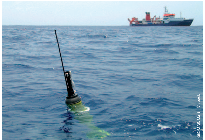
Treiben lassen für die Forschung: Ein frisch ausgesetzter Argo-Tiefendrifter schwimmt im Ozean kurz vor dem Abtauchen.
