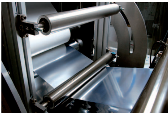
Hochbarrierefolien – hier in einer Lackier- und Kaschieranlage – sind gegenüber Umwelteinflüssen und mechanischer Beanspruchung stabilisiert.
