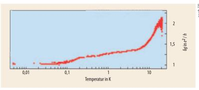
Bei tiefen Temperaturen reduziert sich der Leitwert in Quantendrähten um den Faktor zwei zu  $1 \cdot e^2/h$ . Eine mögliche
