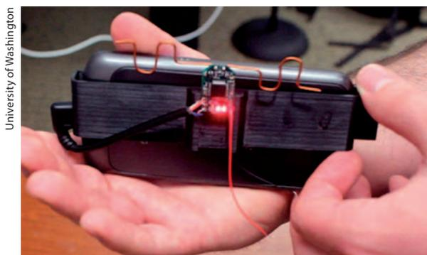
Aufgesetzt auf ein Smartphone erkennt der Radiofrequenzsensor Gesten selbst dann, wenn das Gerät in der Hosentasche steckt.
