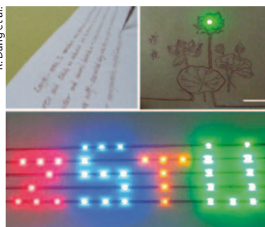
Mit der kupferplättchenhaltigen Tinte kann man schreiben und funktionsfähige Leiterbahnen aufmalen.
