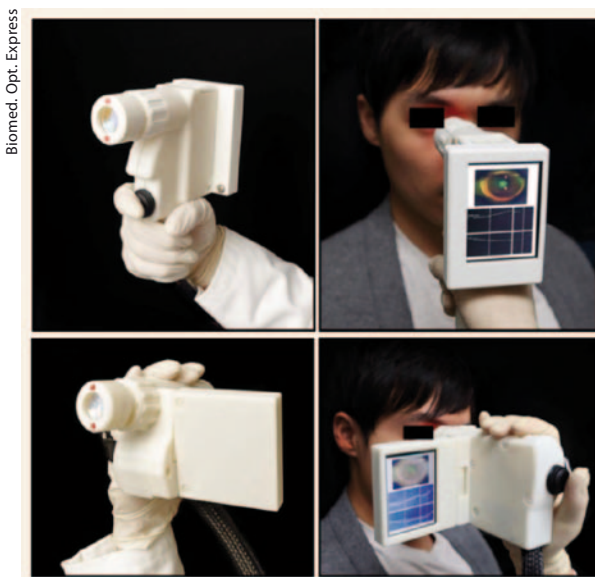
Die mobilen OCT-Instrumente haben unterschiedliche Bauformen (oben bzw. unten), aber eine identische optische Funktionsweise.
