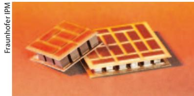
Die Quader des thermoelektrischen Materials haben die Forscher auf einer Keramikplatte befestigt und über ein Lötverfahren mit Kupferelektroden kontaktiert.
