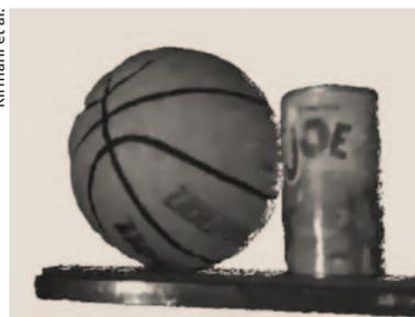
3D-Rekonstruktion eines Balls und einer Dose mit der Erstphotonenbildsynthese.
