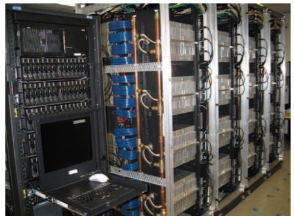
Abb. 6 Der Supercomputer QPACE (QCD Parallel Computing on the Cell) wurde an der Universität Regensburg speziell für QCD-Simulationen entwickelt.
