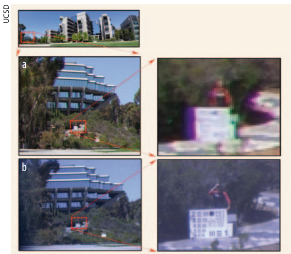
Im Vergleich zu der Aufnahme einer klassischen Spiegelreflexkamera (a) lassen sich Objekte mit der in Kalifornien entwickelten monozentrischen Optik schärfer abbilden (b).
