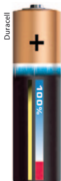
Abb. 1 Bei diesem Batterietester spricht eine dünne Schicht thermochromer Tinte, die auf einem Leukofarbstoff beruht, auf Wärme durch Fingerkontakt an. Je wärmer die Schicht wird, desto transparenter ist sie.
