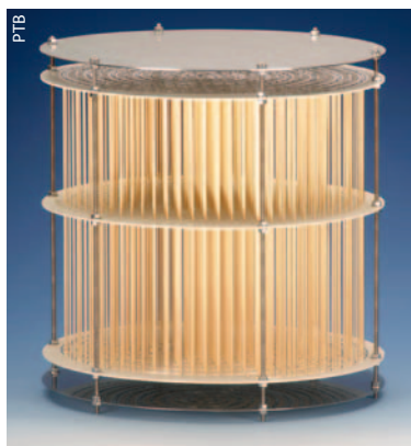
Das neue TransfERNormal der PTB misst niedrige Radon-Aktivitätskonzentrationen mit geringer Messunsicherheit.
