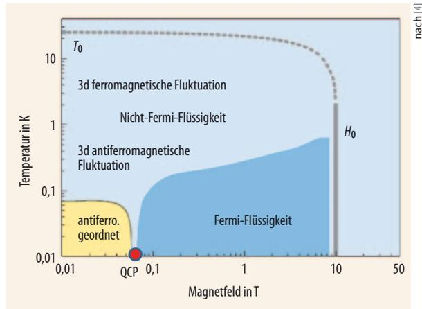
Abb. 3 In der Schwere-Fermionen-Verbindung  $\text{YbRh}_2\text{Si}_2$  tritt der quantenkritische Punkt bei  $H \approx 65$  mT auf. Die Temperatur  $T_0$  ist in etwa die Kondo-Temperatur,  $H_0$  ist ein entsprechendes Magnetfeld.
