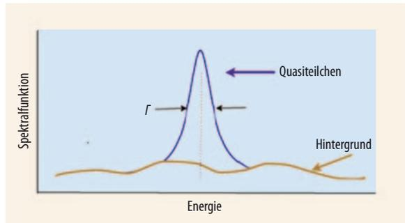
Abb. 1 In einem Metall machen sich elektronische Anregungen wie ein Quasiteilchen in der Spektralfunktion bemerkbar. Das Quasiteilchengewicht  $Z$ , d. h. die eingeschlossene Fläche, ist kleiner als 1.
