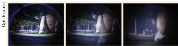
Bilder, wie sie das Modellauge sieht (von links): mit voll funktionsfähigem Auge, mit Kontaktlinse und beiden optischen Wegen bzw. nur mit dem vergrößerten optischen Weg. Im mittleren Bild führt die Überlagerung der beiden optischen Wege zu einem reduzierten Kontrast.
