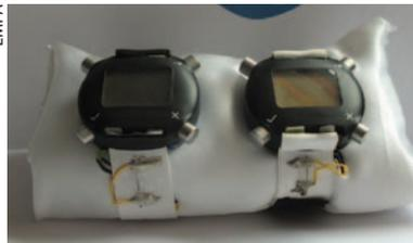
Prototyp des Blutdruckmonitors mit einem Band aus piezo-resistiven Fasern.
