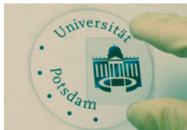
Das rotationsbeschichtete Materialmischsystem auf durchsichtigem Substrat bietet hohe Transparenz.
