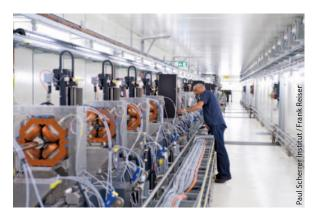
Die Technologien für den ersten Teil des SwissFEL-Beschleunigers werden im Tunnel des 250-MeV-Injektors getestet.
