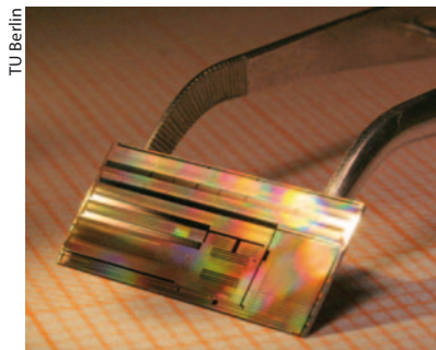
Optische Modulatoren aus Silizium (hier auf einem Testchip) sind wichtig für die künftige Datenkommunikation.
