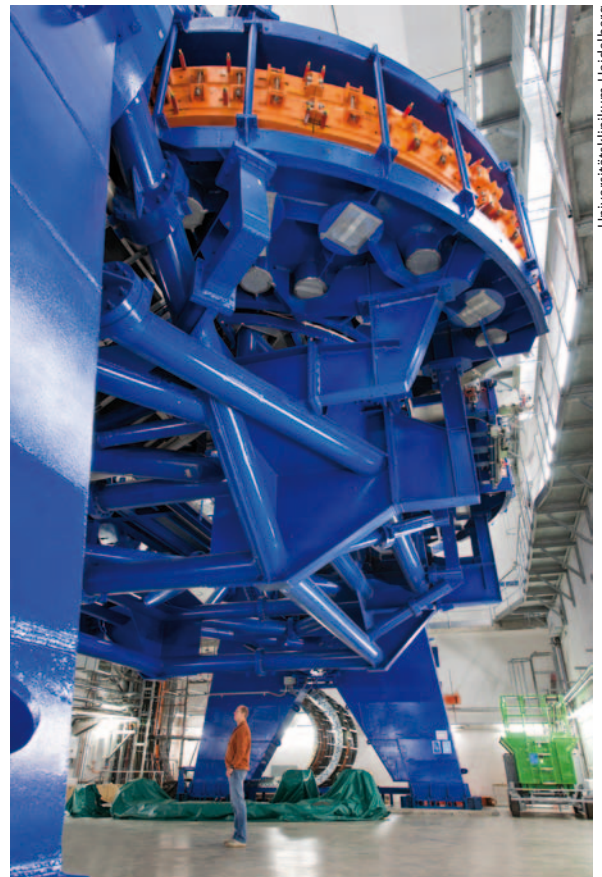
670 Tonnen schwer, 25 Meter lang, 13 Meter im Durchmesser und drei Stockwerke hoch – dies sind die beeindruckenden Maße der Gantry am HIT, eines weltweiten Unikats. Zentraler Teil davon ist ein normalleitender 2-Tesla-Eisenmagnet zur Ablenkung der hochenergetischen Teilchenstrahlen, der allein 90 Tonnen wiegt (orange).
