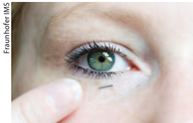
Der dünne Biosensor für die Blutzuckermessung lässt sich im unteren Augenlid tragen.
