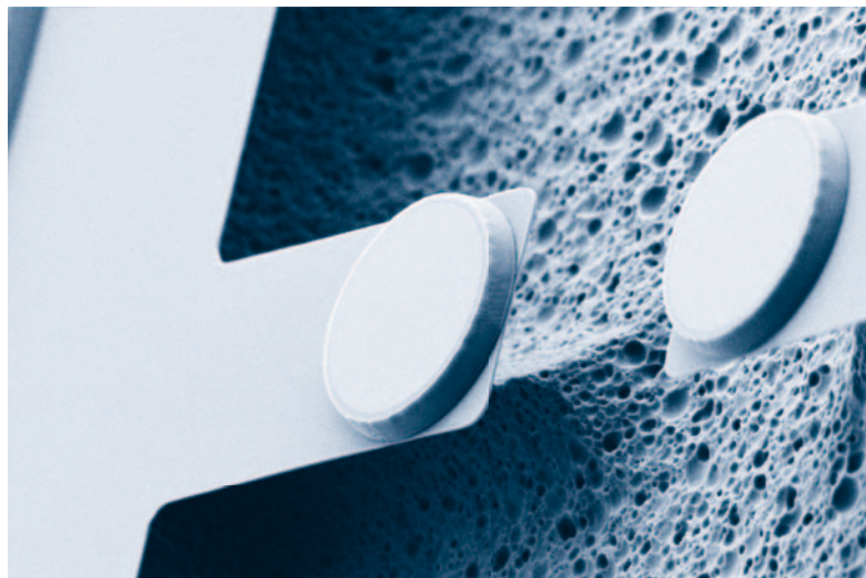
Abb. 1 Optomechanische Strukturen: Die kreisförmigen Spiegel mit etwa 40 \mu\text{m} Durchmesser sitzen auf einem elastischen Balken aus Siliziumnitrid und
