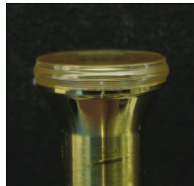
Abb. 5 Zukünftige Terahertz-Quelle: ein 6 mm großer Flüstergaleriemoden-Resonator aus Lithiumniobat.
