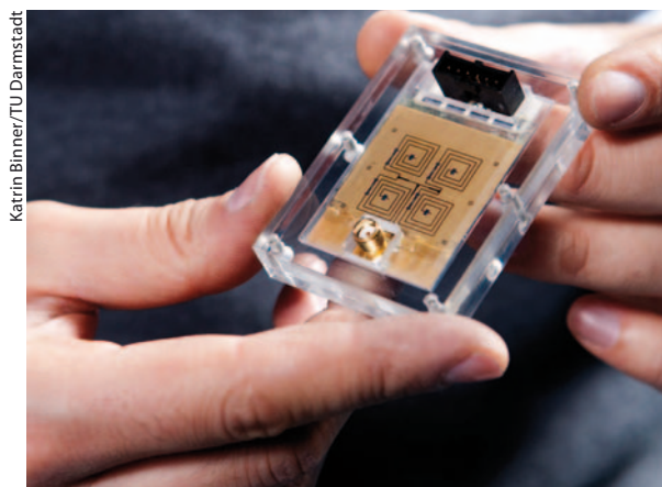
Phased-Array-Antennen mit Verzögerungsstrecken aus Flüssigkristallelementen (im Bild ein Demonstrator mit zwei mal zwei Zellen) sind sehr flach.
