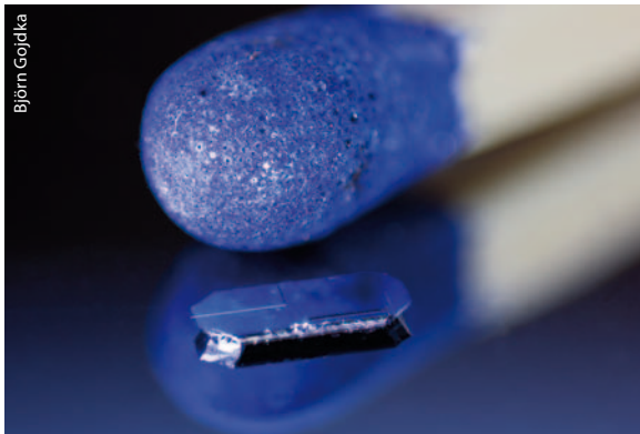
Der Kieler magnetische Sensor ist nur 125 Mikrometer lang. Er ist am Ende des Siliziumchips zu sehen.
