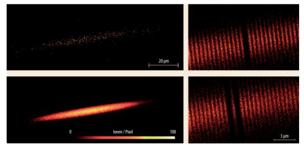
Mit dem Elektronenmikroskop lässt sich ein Bose-Einstein Kondensat aus Rubidium in der Falle abbilden (links oben). Die Überlagerung aus 300 solche Einzel-
