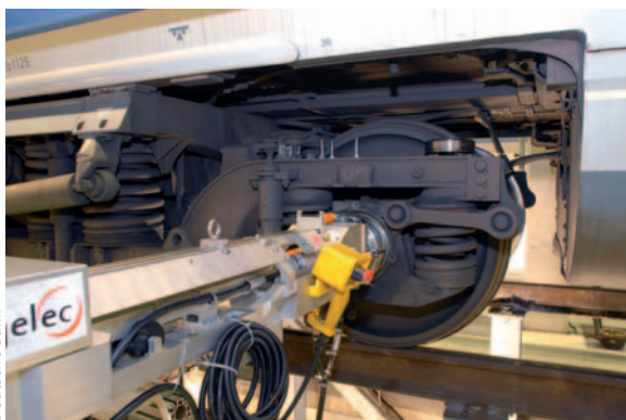
Abb. 1 Im ICE-Betriebswerk Berlin Rummelsburg wird ein Hohlwellenprüfstand am Radsatz montiert.
