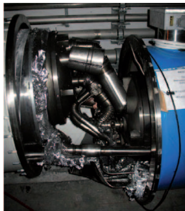
Die Zerstörungskraft des verdampfenden Heliums war so groß, dass bei dem Unfall am Large Hadron Collider
