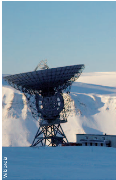
Ein Upgrade des EISCAT-Radarsystems, mit dem sich verschiedene Prozesse der Erdatmosphäre untersuchen lassen, ist eines der Projekte in der ESFRI-Roadmap.
