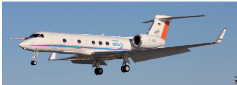
Das neue deutsche Forschungsflugzeug Halo im Anflug auf Oberpfaffenhofen: Gut zu erkennen ist die Messlanze am Bug des Flugzeugs.
