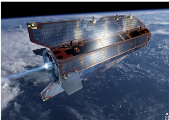
Der runde fünf Meter lange ESA-Satellit GOCE bildet mit den Beschleunigungsmessern, Sensoren und Kontrolleinheiten in seiner Gesamtheit ein hochempfindliches Gravitationsmessgerät.
