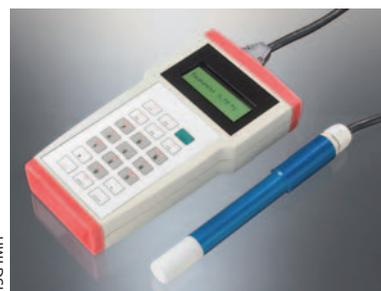
Den Prototyp des Taupunktssensors gibt es derzeit als Handmessgerät (Bild) und in druckfester Ausführung für Leitungen.
