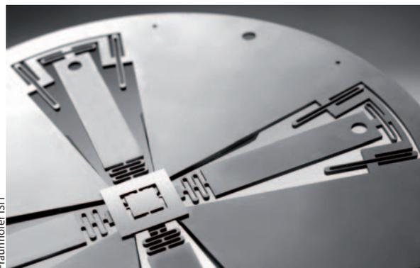
Der Dehnungssensor aus Silizium ist auf einen Transducer aus Stahl aufgeklebt.
