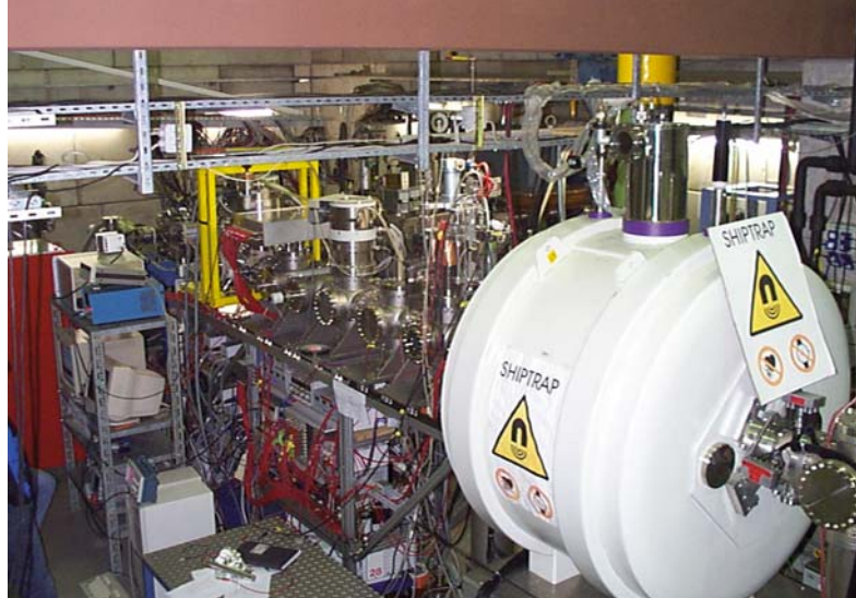
Abb. 1 In der SHIPTRAP-Anlage werden Nobelium-Ionen mit einem Puffergas gestoppt und in eine Penning-Falle gebracht. Aus der Zyklotronfrequenz der im Magnetfeld der Falle umlaufenden Ionen ließ sich deren Masse mit einer relativen Genauigkeit von 10^{-7} messen.
